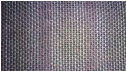
Suprafetele textile tesute care contin microfiliate bicomponente: Fir clasic (batatura) – alb, Fir clasic dublat cu microfiliate (urzeala) – roz si galben
